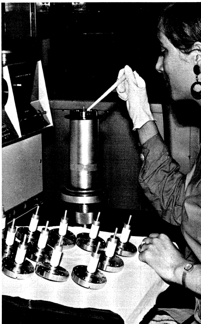
Contrôle d'étanchéité des 1500 traversées étanches équipant les anneaux de stockage. Service ISR.
